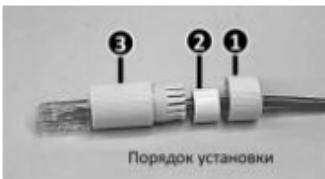
3 Вставьте цилиндрическое водонепроницаемое кольцо в болт.
