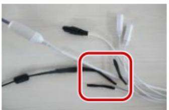
4 Обмотайте все ответвительные кабели изоляционной лентой.
