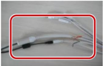
2 Обмотайте соединённые кабели изоляционной лентой.
