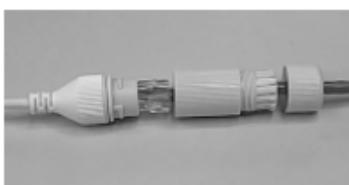
5 Закрутите водонепроницаемый колпачок болта.
